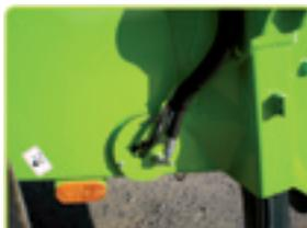
Détails à ne pas négliger, tous les tuyaux passant à l'intérieur du châssis sont en 4 tresses d'acier, pouvant atteindre une pression de 445 BAR, pour une longue durée de vie !
