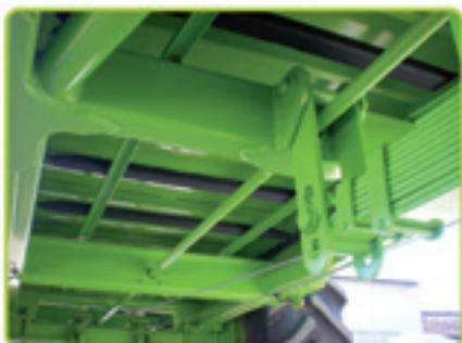
Grâce aux plaques boulonnées qui ferment le châssis étanche à chaque bout ainsi qu'à côté de l'essieu, le remplacement des flexibles hydrauliques se fait très facilement.
